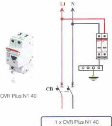
มี MCB ป้องกันติดตั้งภายใน SPD
